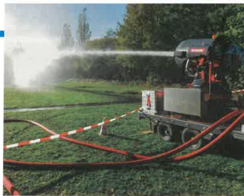
Viel beachtet: Die mobile Löschturbine „MXOne“ von Minimax bei der Vorführung.
